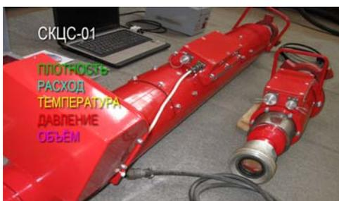
Система контроля технологических процессов цементировании скважин СКЦС-01, производимая ижевской компанией Электротех, предназначена для регистрации плотности, расхода, давления и температуры во время различных работ с нагнетанием жидкостей с переменной плотностью.
