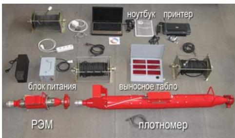
Базовый набор СКЦС включает в себя: плотномер вибрационный, расходомер электромагнитный, блок питания, ноутбук с цветным принтером, выносное табло, соединительные кабели и смотки.
